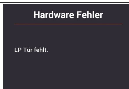
Abb. 5.1.a Fehler bei Systemcheck
